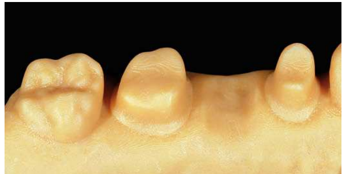
Fig. 3. Superficie lisa de un modelo fabricado con tecnología SL.
