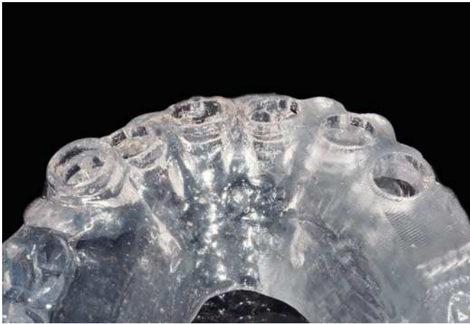
Fig. 1. Plantilla para taladrar hecha en resina estereolitográfica FotoTec SLD.
