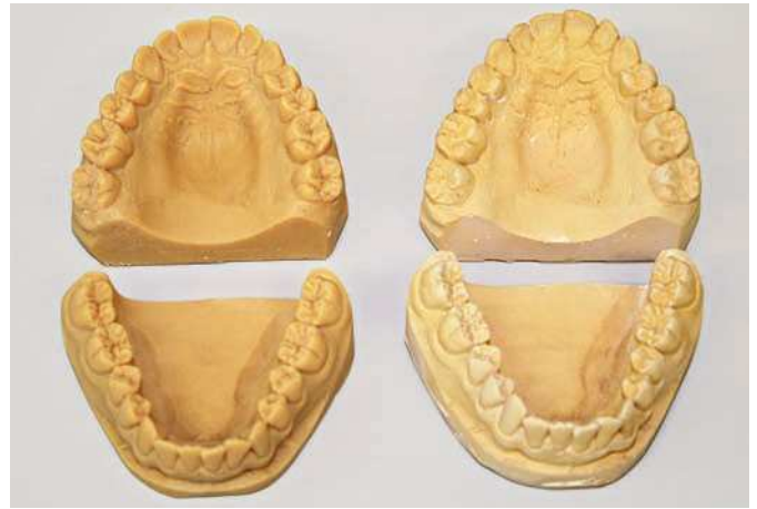
Fig. 2. Modelo dental fabricado de manera generativa (a la izquierda, FotoTecSLA) y un modelo de yeso fabricado de manera tradicional.
