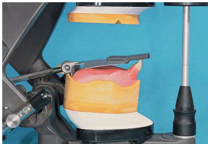
Fig. 4. En la zona de los dientes frontales se coloca el inserto (la placa oscura) sobre el borde de los incisales y en el modelo se ponen en contacto dos puntos de partida situados en la zona posterior con el borde de metal del indicador de inclinación de las superficies de oclusión.
