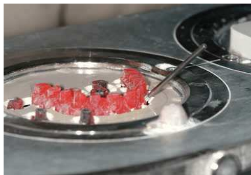
Fig. 15. El puente de resina visto desde basal. Las superficies de contacto con los implantes y con los posteriores tornillos de fijación se palpan a partir de piezas prefabricadas.
