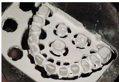
Figs. 17 a 19. Las fresas de metal duro en diferentes formas y tamaños posibilitan la reproducción exacta y detallada del modelo de estructura en material de dióxido de zirconio.
