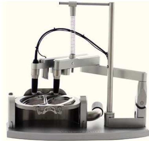
Fig. 1a. La fresadora-copiadora Zirkograph 025 ECO de la empresa Zirkonzahn con cinco ejes/grados de libertad.
