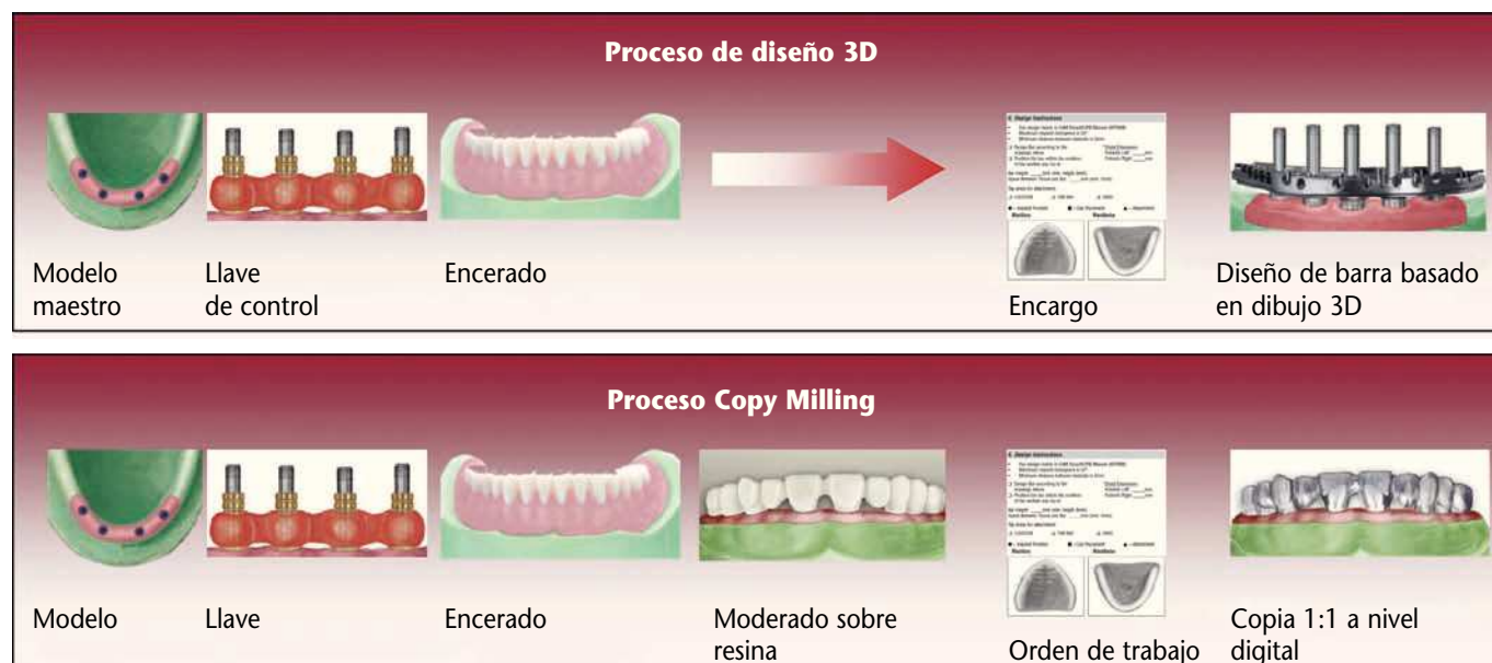
Fig. 1. Comparación de la cadena de proceso entre los modelados virtual y físico de las estructuras.
