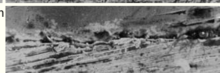
Fig. 10. Ajuste sin intersticio de las cofias galvánicas obtenidas mediante deposición directa; anchura de intersticio máxima: 7,25 \mu m.
