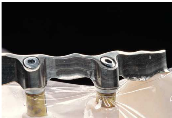
Fig. 29. La barra continua se montó en el modelo, sobre el cual previamente se había tendido una hoja de polietileno (hoja para conservación fresca) para el fresado del metal.
