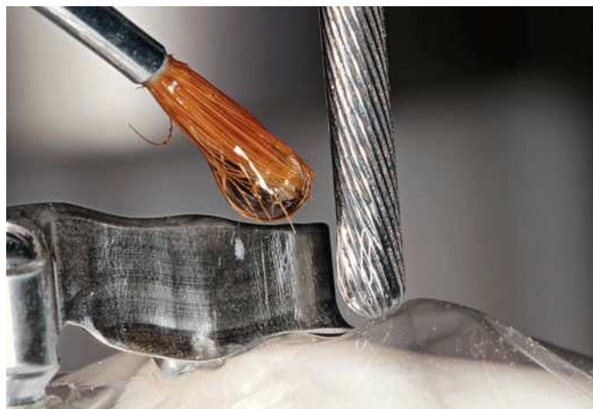
Fig. 30. Las superficies de la barra continua se repasan con un poco de aceite para fresado y con una fresa con dentado transversal y las revoluciones reducidas.
