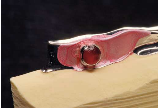
Fig. 33. Se colocaron las envolturas de las conexiones snap y se fijaron en forma circular con barniz conductor de plata; los canales de los tornillos quedaron libres.
