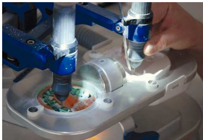
Fig. 17. Proceso sincrónico de palpación y fresado durante el fresado con copia.
