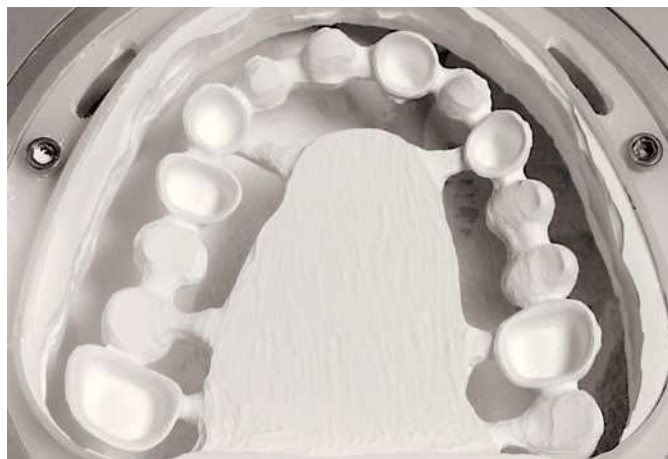
Fig. 25. El armazón con los puentes de unión necesarios para el sinterizado, antes de la separación de la pieza bruta.
