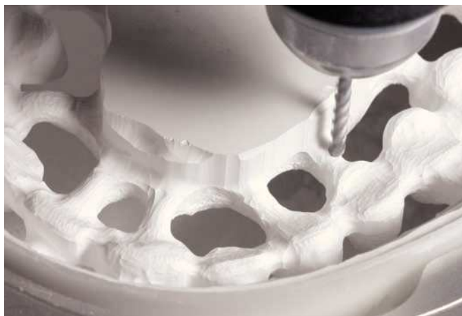
Fig. 24. La separación de los puentes de unión en la fresadora-copiadora Ceramill base.
