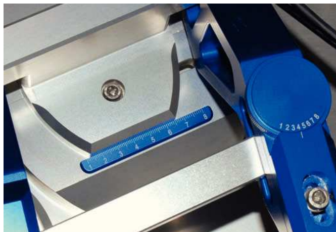
Fig. 3. Factor de ampliación variable (Ceramill Base, Amann Girrbach, Pforzheim).
