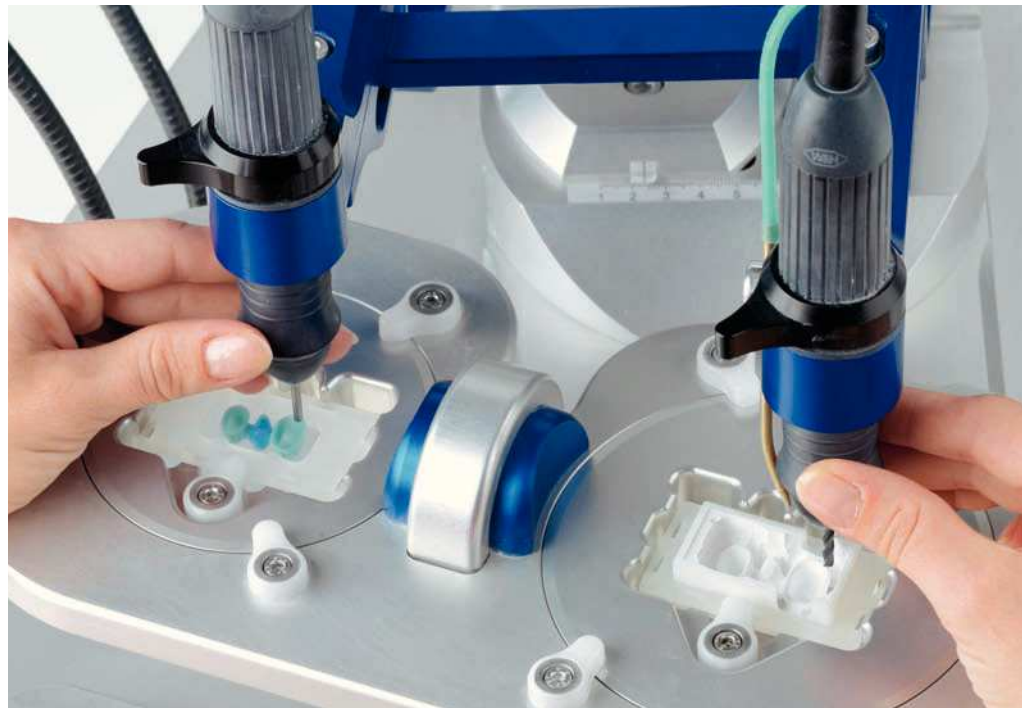
Fig. 1. El fresado con copia.
