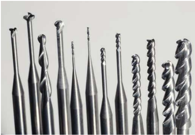
Fig. 20. El surtido de fresas Ceramill roto (diámetro del vástago: 3 mm).
