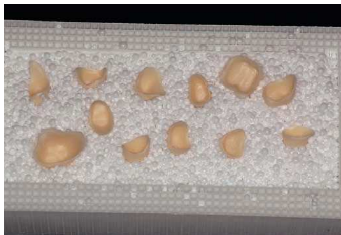
Fig. 4. Una bañera especial de sinterizado aloja los objetos que yacen sobre las bolitas de zirconio.
