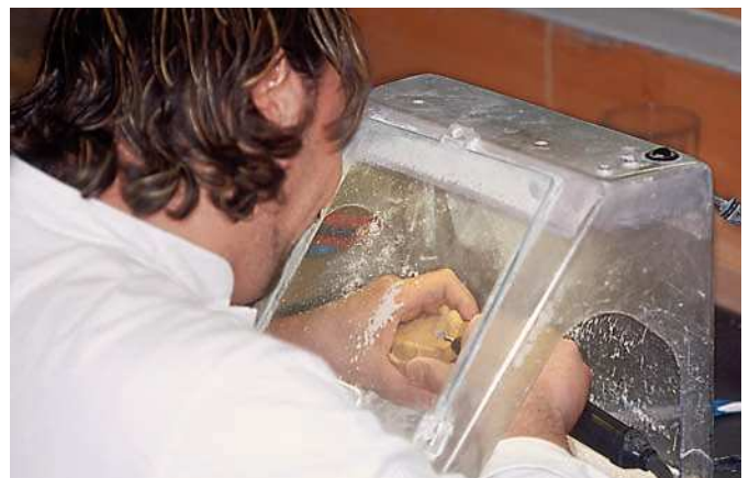
Fig. 4. Cajas de trabajo especiales en lugares de trabajo expuestos al polvo para el rectificado de modelos.
