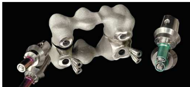
Fig. 14. Tras el arenado con óxido de aluminio, las estructuras están preparadas para la oxidación.
