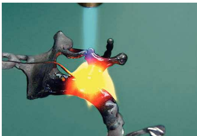
Fig. 5. Los objetos grandes se tienen que calentar de manera uniforme. La elección del quemador aquí es importante.
