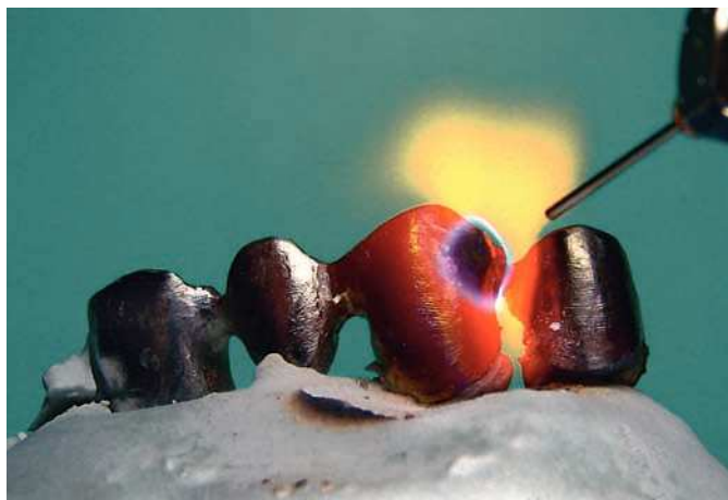
Fig. 3. Falsa posición de la llama: la mezcla del gas es demasiado fuerte y la llama prende antes el objeto.
