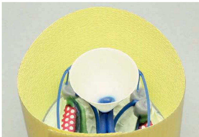
Fig. 16. Modelo con cinta crepé antes del recubrimiento.
