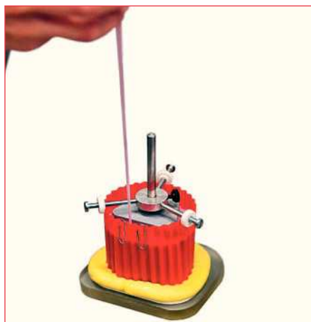
Fig. 13. Duplicación de silicona según el sistema Okta: la silicona fluye con chorro fino en el modelo de duplicación.
