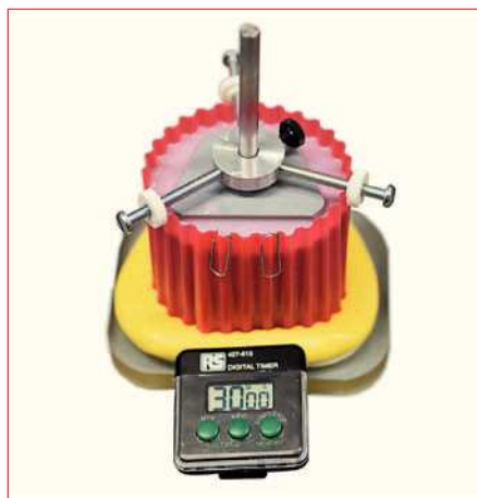
Fig. 14. La placa de estabilización se cuela con silicona de duplicación de viscosidad 24 Shore. El tiempo de endurecimiento de la silicona es de 30 min. La alta viscosidad garantiza la restauración completa del duplicado.
