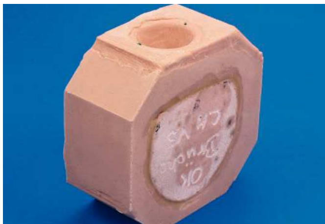
Fig. 18. La cubeta Okta está llena, la masa de recubrimiento se endurece en 60 min.
