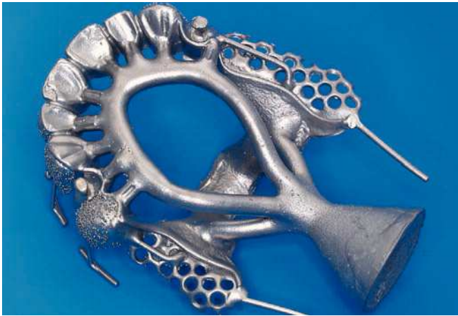
Fig. 21. El colado sobre el modelo de una pieza se arena con corindón sólo sobre la parte de arriba. Las superficies interiores se arenan cuidadosamente con perlas de cristal para evitar erosionar las de las coronas secundarias.
