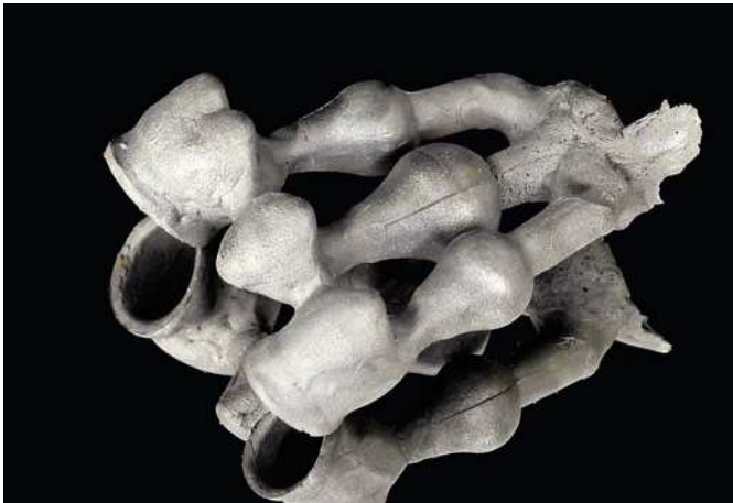
Fig. 3. Después del colado y el enfriamiento, se retira cuidadosamente el recubrimiento del armazón y se somete a un chorro de óxido de aluminio. A continuación el armazón se ajusta cuidadosamente y se retoca la superficie con fresas de metal duro.
