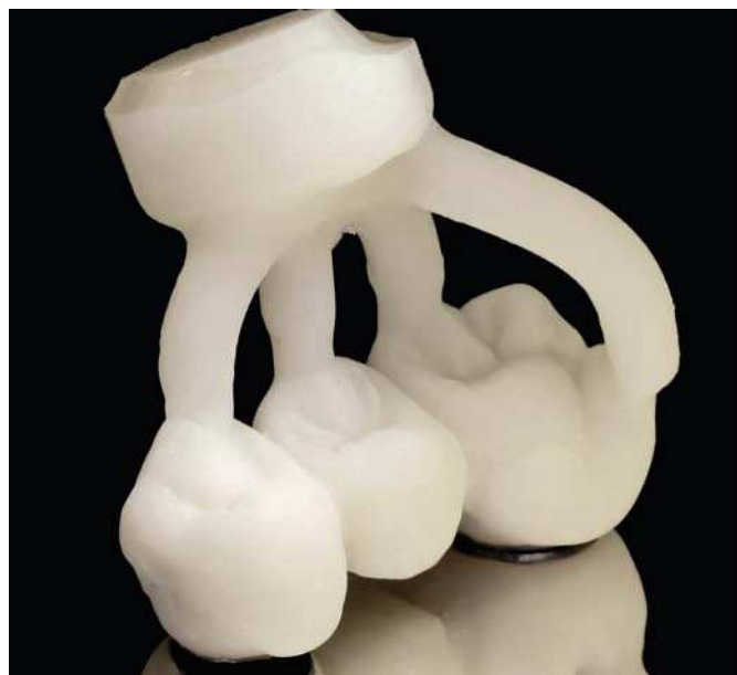
Fig. 13. Los canales de compresión deben tener 3 mm de grosor, no deben medir más de 8 mm y deben estar fijados en un ángulo de 45 a 60° para que la cerámica viscosa de compresión pueda fluir sin obstáculos.
