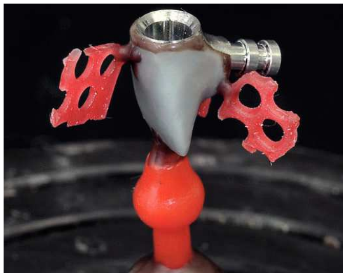
Fig. 6. La pieza colada encerrada sobre el fondo de la mufla: la colocación de los jitos depende del sistema de colado. Para lograr un buen resultado es recomendable disponer canales de enfriamiento.
