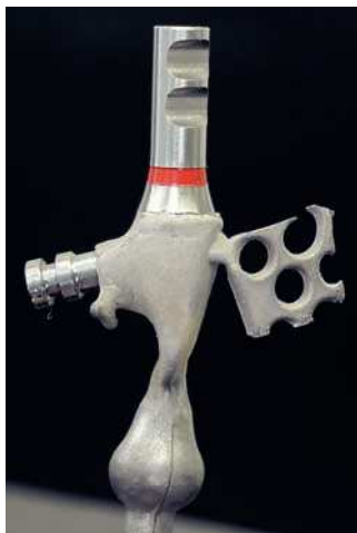
Fig. 8. Para obtener este ajuste exacto es imprescindible llevar a cabo un tratamiento respetuoso durante la retirada del recubrimiento.
