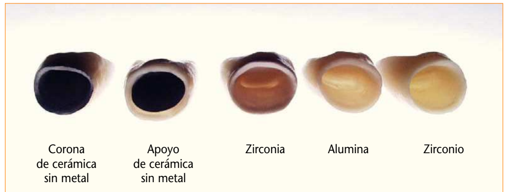
Fig. 7. Las cinco coronas a trasluz. Se ven claramente las diferencias de la fotoconductividad de los materiales.
