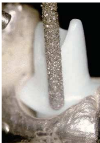
Fig. 45. El acabado de precisión de la construcción fresada utilizando fresas de diamante. Cualquier sobre calentamiento podría poner en peligro la estática, de modo que debe ser prevenido mediante refrigeración desde toberas de agua y aire (imagen de microscopio estereoscópico Zeiss OPMI 19-FC con 6 aumentos).
