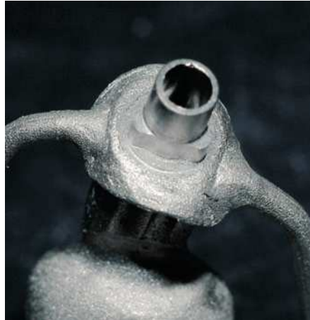
Fig. 17. El colado de oro. Obsérvense los canales de refrigeración y la perfecta unión entre la aleación de oro y la pieza secundaria. La masa fundida no debería fluir sobre el mecanismo de fijación de la pieza secundaria.
