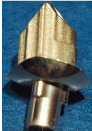
Fig. 23. La pieza secundaria telescópica provisional tras la galvanización con oro casi puro (99%). Cabe destacar la sección transmucosal finamente pulida y el perfil de salida en relación con la superficie de fijación: cementabilidad optimizada mediante una geometría de fresado inusual y chorreado (imagen de microscopio estereoscópico Zeiss OPMI 19-FC con 6 aumentos).
