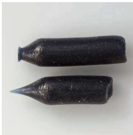
Fig. 11. El canal de colado afilado.
