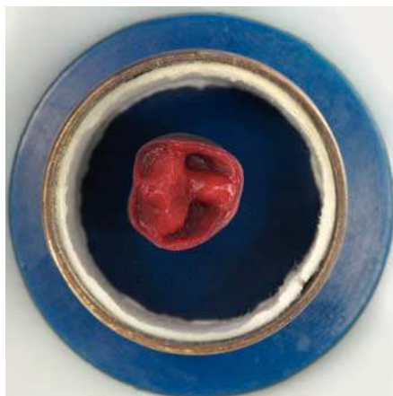
Fig. 10. El objeto en una primera mufla con banda de expansión.
