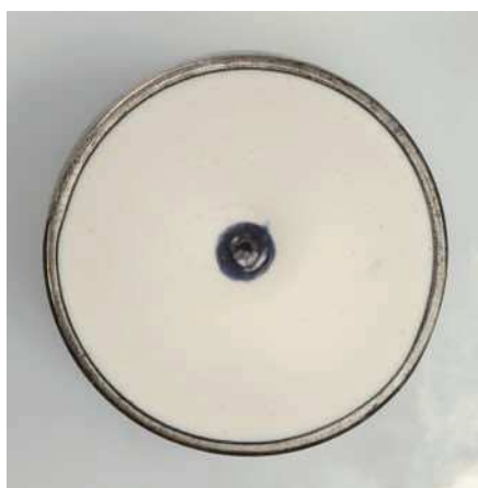
Fig. 15. La mufla lista desde la posición basal para el horno precalentado.
