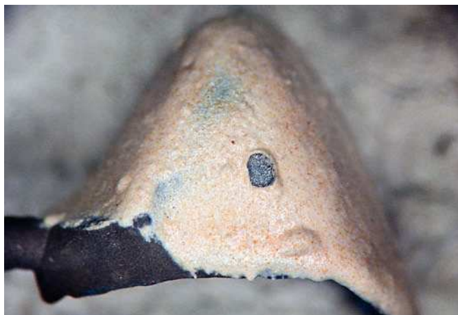
Fig. 11. Burbujas en el opáquer y en una aleación de alto contenido en oro.
