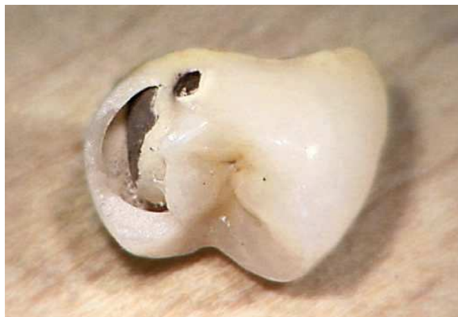
Fig. 12. Fuerte formación de poros/burbujas entre el opáquer y una aleación.
