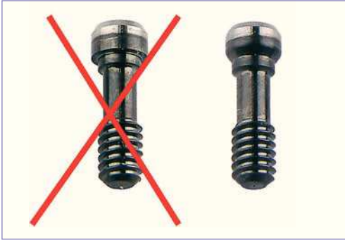
Fig. 25. Para los pilares de óxido de zirconio deben utilizarse tornillos de titanio especiales redondeados en el hombro del tornillo. Con ello se evita una fractura de la cerámica, altamente resistente pero sin embargo quebradiza.
