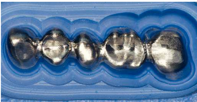
Fig. 42. Geometría externa fresada del armazón de titanio.
