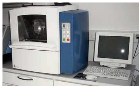
Fig. 11. Everest Engine es la máquina fresadora de 5 ejes del sistema KaVo Everest.
