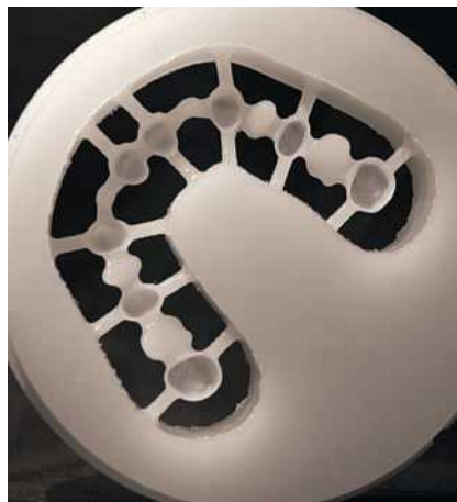
Figs. 15 y 16. Armazón para puente C-Temp de 14 piezas en la pieza cruda presada y en el modelo seccionado.
