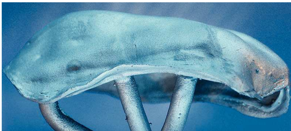
Fig. 5. Base de metal rectificada después del colado de titanio.
