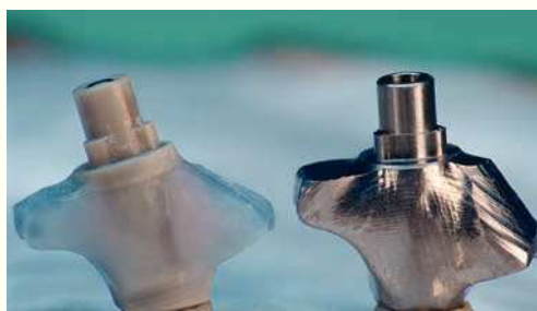
Figs. 20 y 21. Tras la lectura con el escáner, este conjunto de datos se envía a Suecia. Allí se lleva a cabo el modelado 1:1 en titanio.
