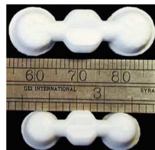
Fig. 6. Armazón fresado de Vita-YT tras un sinterizado completo (arriba o abajo). Se aprecia una contracción considerable.
