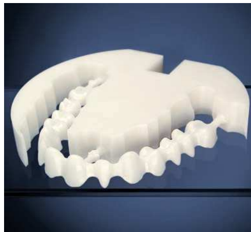
Fig. 2. Armazón de dióxido de zirconio pulido.
