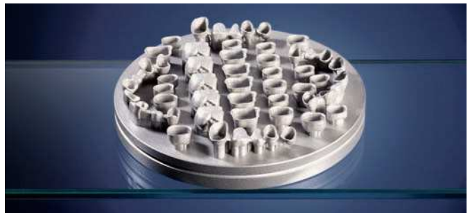
Fig. 5. Armazones de aleación de cromo-cobalto sinterizados con láser.
