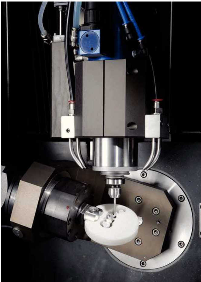
Fig. 4. Máquina fresadora en el proceso de pulido del dióxido de zirconio comprimido isostáticamente a alta temperatura.
