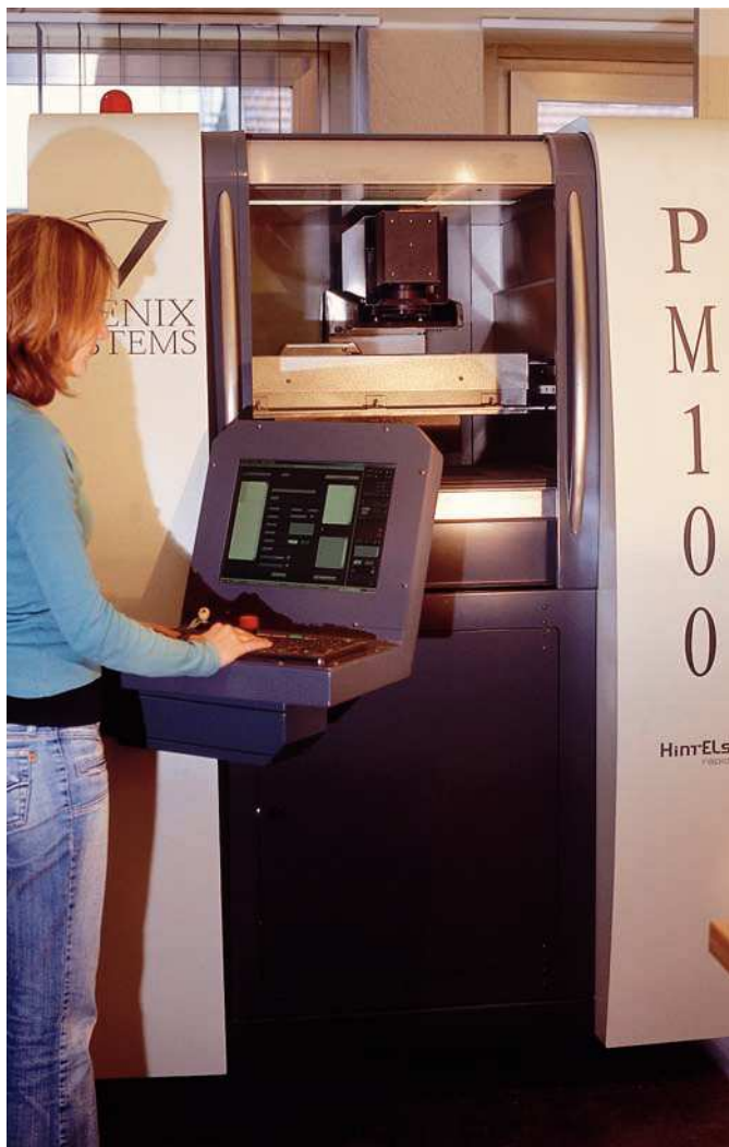
Fig. 9. Ajuste del dispositivo de sinterización por láser.
