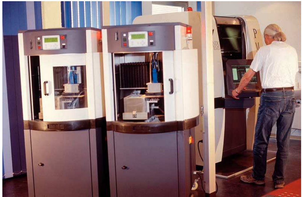
Fig. 1. Los sistemas de fresado y un dispositivo de fusión por láser constituyen la base de la fabricación moderna.
