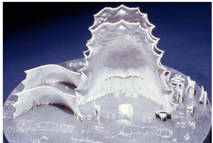
Fig. 6. El tamaño de las placas palatinas exige la superposición de muchas capas de sinterización.
