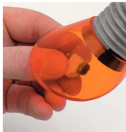
Fig. 4. Polimerizado del material sintético aplicado con la lámpara LED ultravioleta Ceramill.
