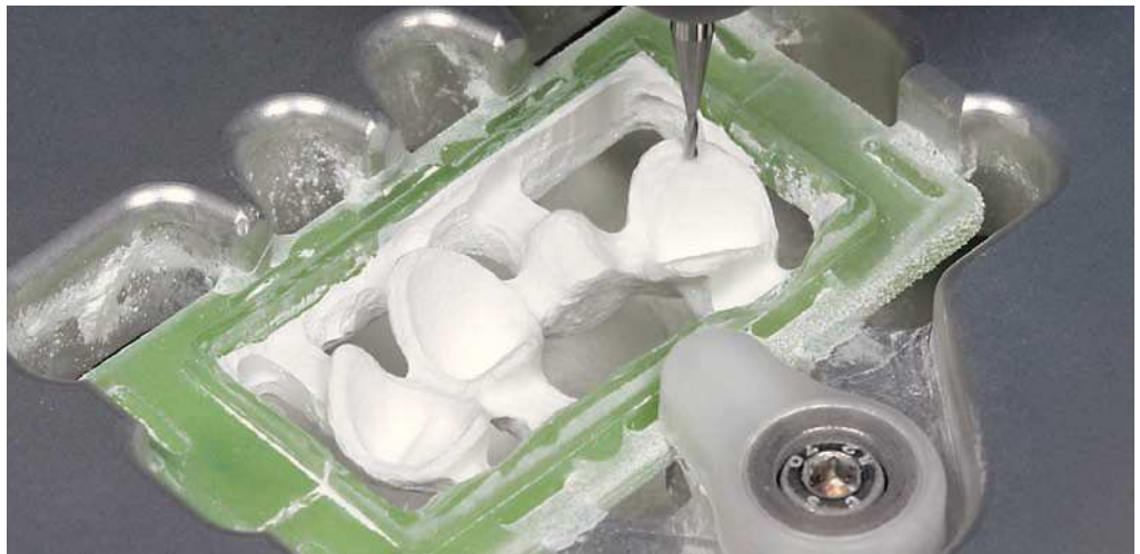
Fig. 21. Procesamiento del borde de la corona y de la superficie interior con una fresa de 1,2 mm.
