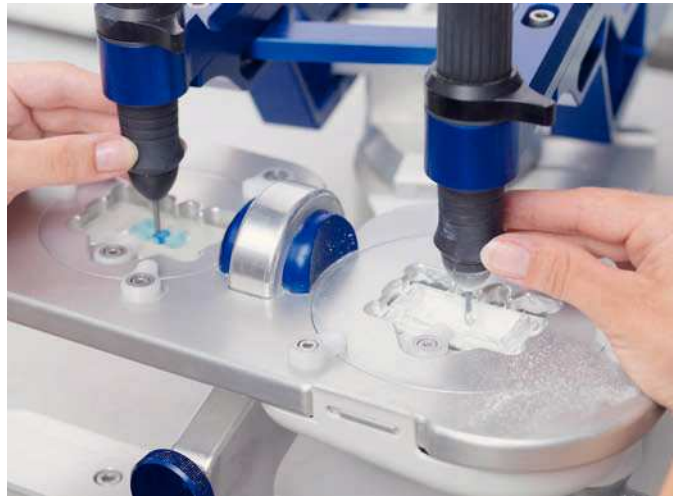
Fig. 14. El funcionamiento de la fresadora-copiadora: exploración con un procesamiento sincrónico.
