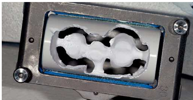
Fig. 1. Pieza bruta Cercon base durante el proceso de fresado antes de la sinterización.
