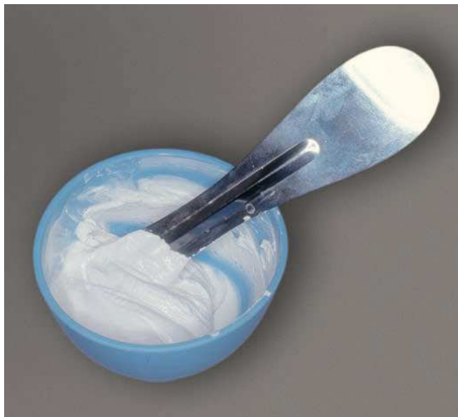
Fig. 26. Mezclado. El polvo de yeso se mezcla completamente con el agua con una espátula a mano y se procura que los bordes del recipiente estén limpios. Al final del proceso de mezclado, debe existir una pasta de yeso cremosa y homogénea.
