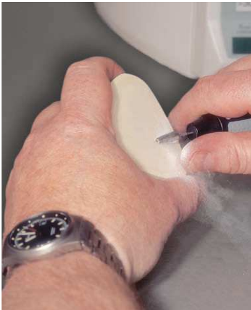
Fig. 22. Inserción de retenciones en el modelo. En las superficies basales del modelo se esmerilan con el portátil y una fresa gruesa para yeso (SGEA, SGFA) estructuras de cifrado y recursos de ayuda para retenciones (socavaciones) para el yeso de articulación.
