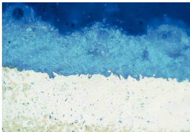
Fig. 31. Unión defectuosa en una funda irradiada. LM, luz incidente, aumento de 100:1.
