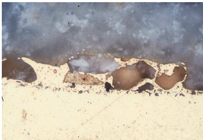
Fig. 29. Cocción defectuosa del material de bonderización sin fusión con la funda. LM, luz incidente, aumento de 200:1.
