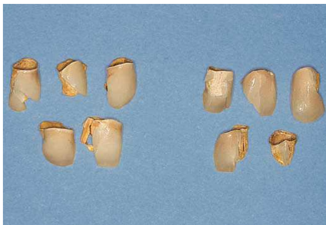
Fig. 30. Lotes de cinco fundas para coronas irradiadas o bonderizadas y recubiertas tras la destrucción con los alicates cónicos.
