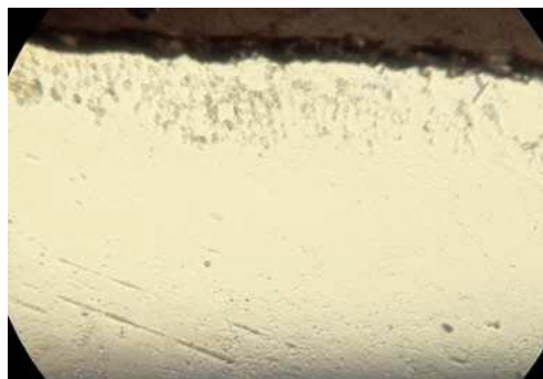
Fig. 2. Corte del armazón de titanio con defectos masivos en la región marginal (arriba), corrosión de Kroll. LM, luz incidente, aumento de 100:1.
