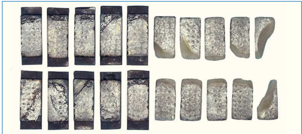
Fig. 32. Pieza cizallada con 4 x 8 puntos de láser tras un ensayo de adherencia con TiBond.
