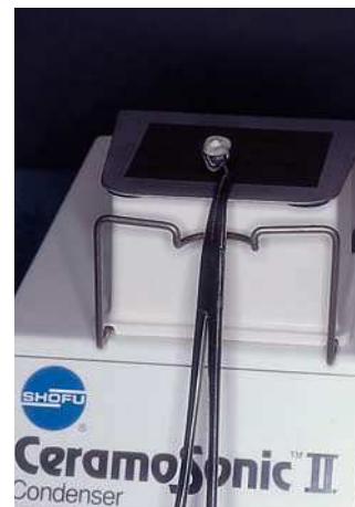
Fig. 32. Aplicación de la segunda capa de opáquer y compresión de la barbotina cerámica con un compresor de ultrasonidos.
