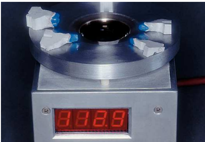
Fig. 6. Precalentamiento y fabricación de la funda de cera.
