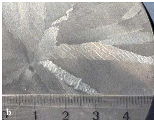
Figs. 4a y 4b. Pieza cruda de CrCo para el fresado; a: vista general; b: estructura de colado de grano grueso.
