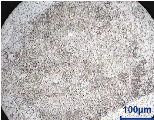
Fig. 6. Estructura de un hilo de soldadura de CrCo de 0,5 mm (Dentaurum).
