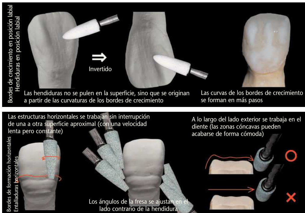
Fig. 13. La estructura vertical (bordes de crecimiento y hendiduras de la superficie labial). Las formas del exterior y el interior de los bordes de crecimiento: las hendiduras longitudinales no se «tallan» en el material, sino que se forman a partir de las curvaturas de los bordes de crecimiento. Durante la formación, normalmente, el diente debe memorizarse. Las curvaturas de los bordes de crecimiento se trazan de forma óptima con la agregación de material.
