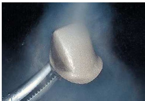
Fig. 19. Limpieza de la pieza de trabajo con un limpiador de vapor. Después del tratamiento con chorro de arena, la pieza deberá bañarse al ácido. Antes de que se produzca la oxidación, deberán eliminarse las últimas partículas de suciedad –sobre todo manchas de grasa y otros cuerpos extraños– con un limpiador de vapor.
