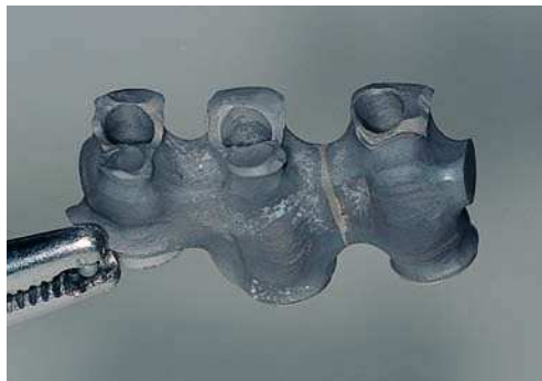
Fig. 8a. Partículas extrañas en el armazón implantosoportado.
