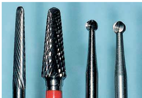
Fig. 4a. Fresas y fresas redondas para la formación del armazón.
