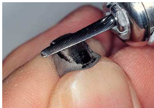
Fig. 6. Dirección incorrecta: así es como se producen distorsiones en la estructura colada en la superficie, lo que provoca deformaciones durante los posteriores tratamientos en caliente.
