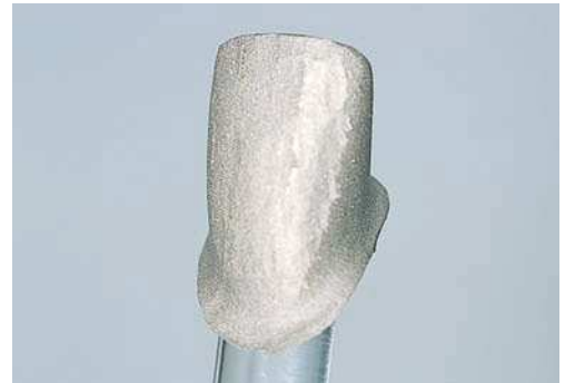
Fig. 7b. Fisuras y manchas cristalizadas en la superficie del armazón.
