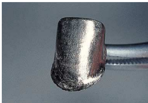
Fig. 18a. Antes del tratamiento con chorro de arena y partículas de óxido de aluminio.
