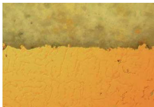
Fig. 9. Zona de unión/capa de óxido de IPS d.SIGN 30 con IPS InLine, aumento 500:1.
