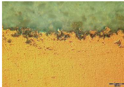
Fig. 7. Zona de unión/capa de óxido de IPS d.SIGN con IPS InLine, aumento 500:1.
