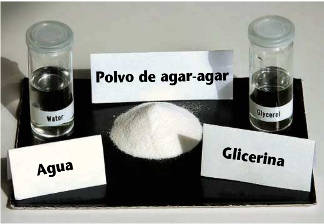
Fig. 2. Componentes principales de una masa de duplicado reversible.
