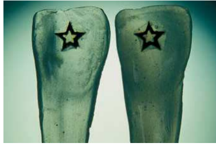
Fig. 52. Dientes de muestra de masas translúcidas. El diente de muestra a la derecha es menos transparente y un poco más gris. El diente de muestra a la izquierda (Window) muestra un grado mucho mayor de transparencia; es prácticamente transparente.
