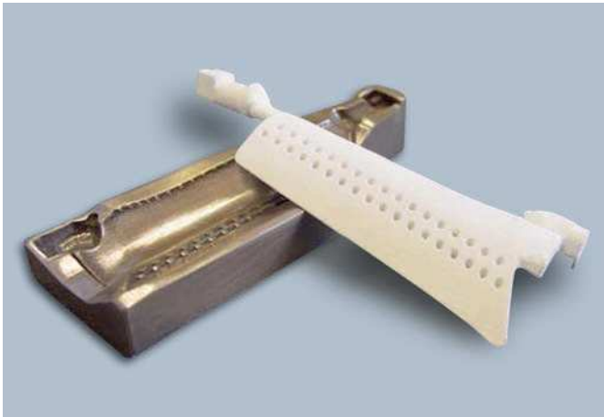
Fig. 2. Piezas de metal y de cerámica sinterizadas por láser.
