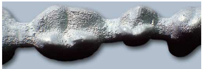
Fig. 29. Calidad de la superficie en la sinterización por láser.
