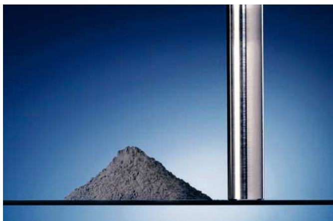
Fig. 12. Material en barra y polvo de CrCo.
