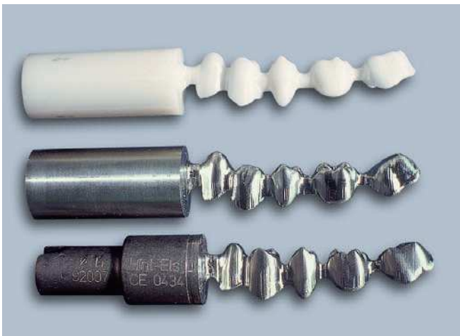
Fig. 36. Variedades de procesamiento en la técnica de fresado: dióxido de zirconio, titanio, cobalto y cromo.
