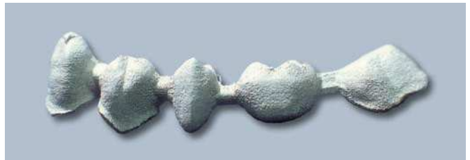
Fig. 27. Puente después de la separación, sinterización por láser.
