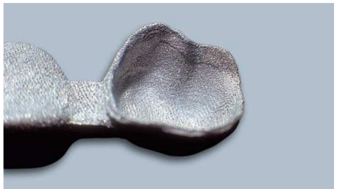
Fig. 31. Cara interna de una corona en la sinterización por láser.
