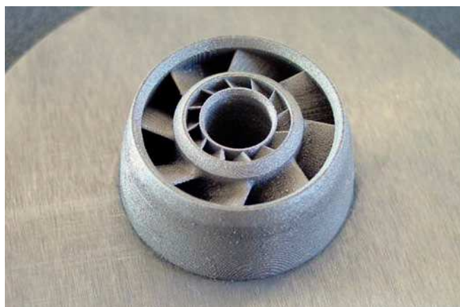
Fig. 13. Turbina hecha de polvo de CrCo.
