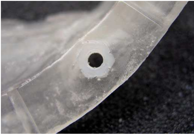
Fig. 8. Una vez acabada la concha anterior, se polimerizaron las tuercas en la concha posterior y se incorporaron los canales de los tornillos y el tope interno en la concha anterior.
