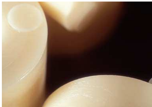
Fig. 3. El acetal es un polioximetileno (POM) termoplástico y sin monómeros.
