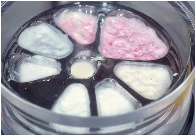
Fig. 19. El laboratorio trabaja con las masas cerámicas Creation de Willi Geller (Zúrich, Suiza); las masas sin usar se evacúan para conseguir una homogeneidad aún mayor (aparato: Calla Plus Ceramic Treatment, Teamziereis).
