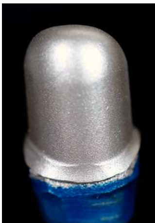
Fig. 9. La aplicación uniforme de barniz conductor de plata sólo es posible con una pistola Airbrush.
