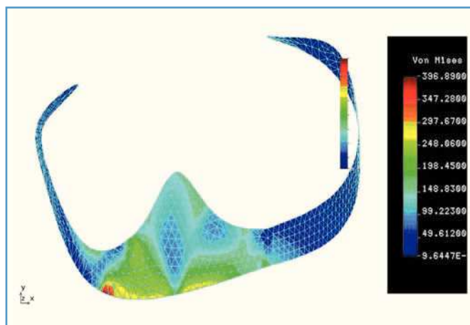
Fig. 14. Distribución de la tensión principal de von Mises provocada por la fuerza de carga (20 N) y la temperatura (60 °C).
