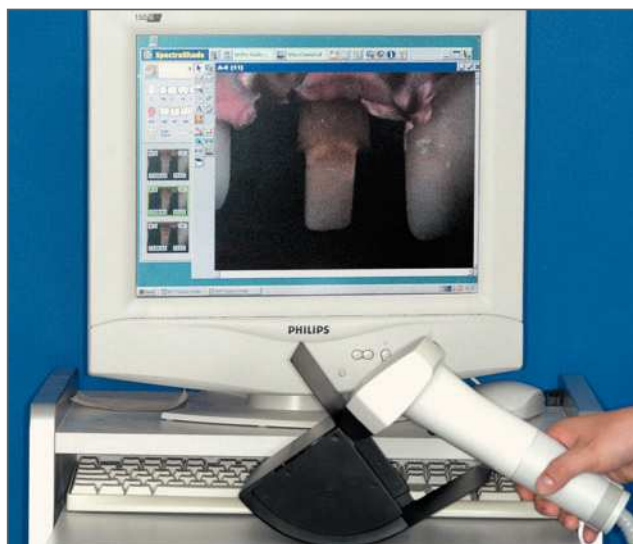
Figuras 2a y 2b. Valoración espectrofotométrica del color en un maxilar artificial situado en una caja que simulaba la cavidad oral.
