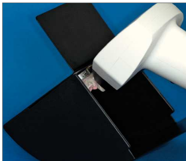
Figuras 2a y 2b. Valoración espectrofotométrica del color en un maxilar artificial situado en una caja que simulaba la cavidad oral.
