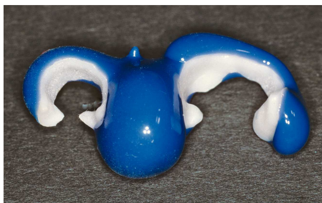
Figura 14. Durante el tratamiento previo de la superficie interna de la estructura mediante chorreado se cubrieron con poliéter las porciones recubiertas.
