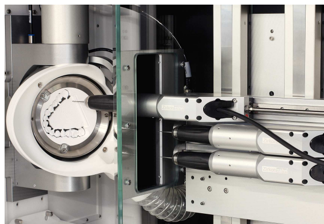
Figura 9. Unidad fresadora de gran tamaño (empresa Zirkonzahn) con herramientas sustituibles automáticamente.
