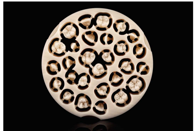
Figura 6. Gran pieza bruta de óxido de zirconio de una instalación de fabricación industrial (empresa Zirkonzahn).
