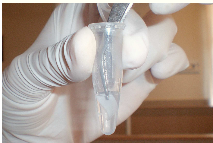
Figura 5. Suspensión de la tira Durapore en suero salino tamponado con fosfato previa a la agitación con vórtex.
