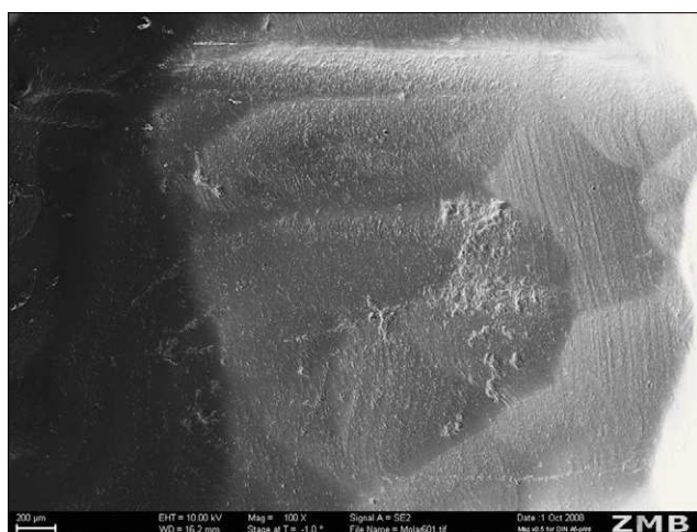
Figura 5b. Imagen global al MEB de la región oclusal de la PDF de la fig. 5a. Se observa una faceta de desgaste clara después de un año de servicio clínico (100 X originales).
