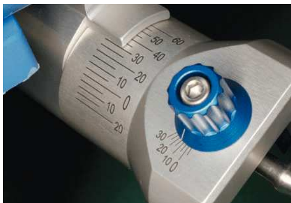
Figura 14. Se pueden leer el ángulo de la trayectoria condílea (escala mayor, unos 30°) y el ángulo de Bennett (escala menor, unos 15°).
