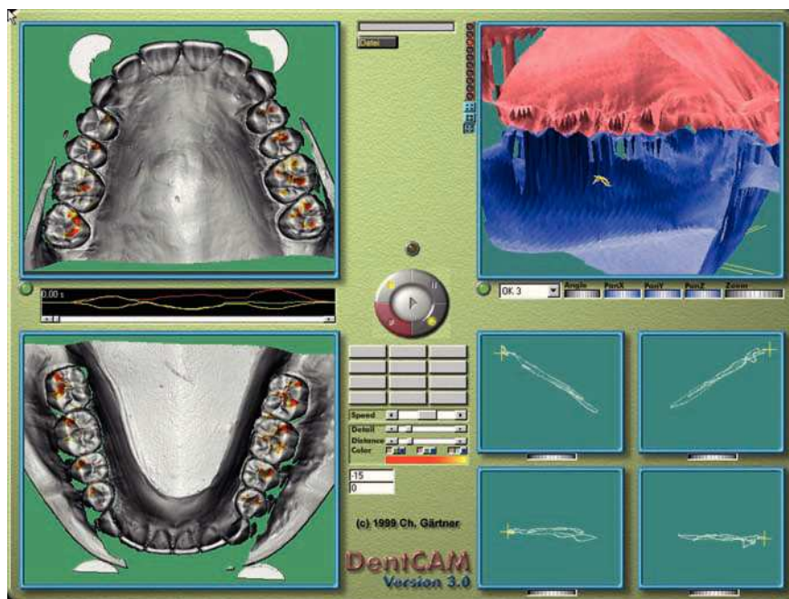
Figura 4. Interfaz de usuario del software del articulador virtual DentCAM: dos ventanas a la izquierda que muestran los puntos de contacto estáticos y dinámicos del maxilar y la mandíbula con marcas de color para visualizar la «intensidad» de los puntos de contacto, una «ventana de representación» situada arriba a la derecha para la vista global, y cuatro ventanas adicionales abajo a la derecha para visualizar las trayectorias condíleas en los planos lateral y horizontal; la ventana de planos de corte está oculta y se abre cuando es necesario.
