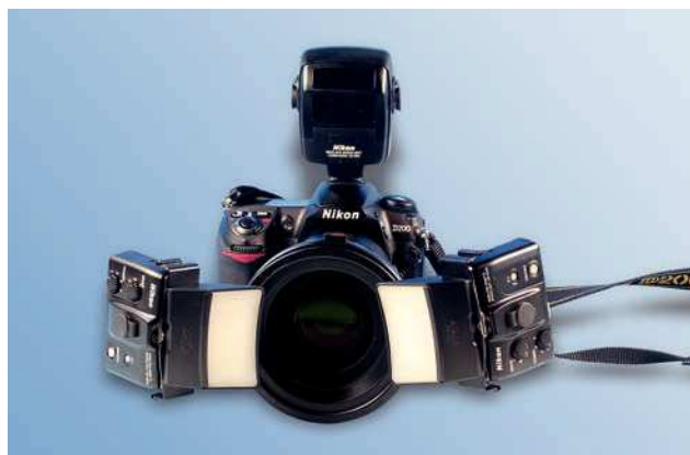
Figura 7b. Los reflectores de aproximación dirigen la luz hacia el eje óptico de la cámara.
