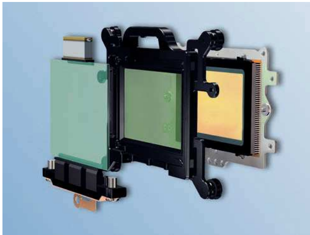
Figura 17. Una forma de evitar la acumulación de polvo en el sensor es el empleo de un filtro, que se limpia automáticamente gracias a un sistema de ultrasonidos.
