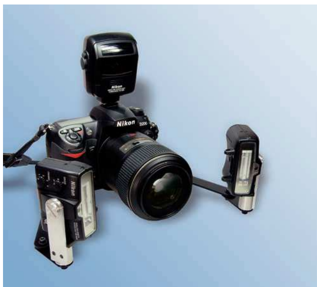
Figura 8. El soporte para flash de Binz permite aproximar la fuente de luz al eje óptico.
