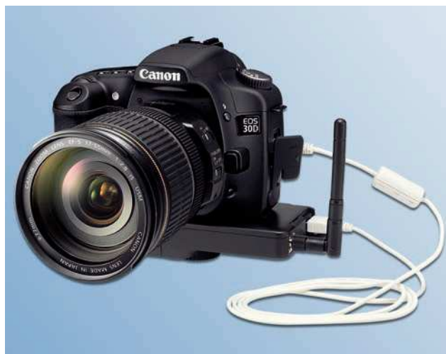
Figura 16. La W-LAN posibilita la transferencia inalámbrica de imágenes.
